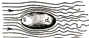
S = point d'arrêt
