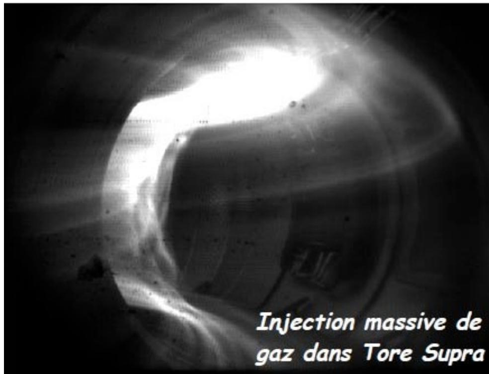
**Le gaz rare injecté « rebondit » sur la « surface résonante »**
