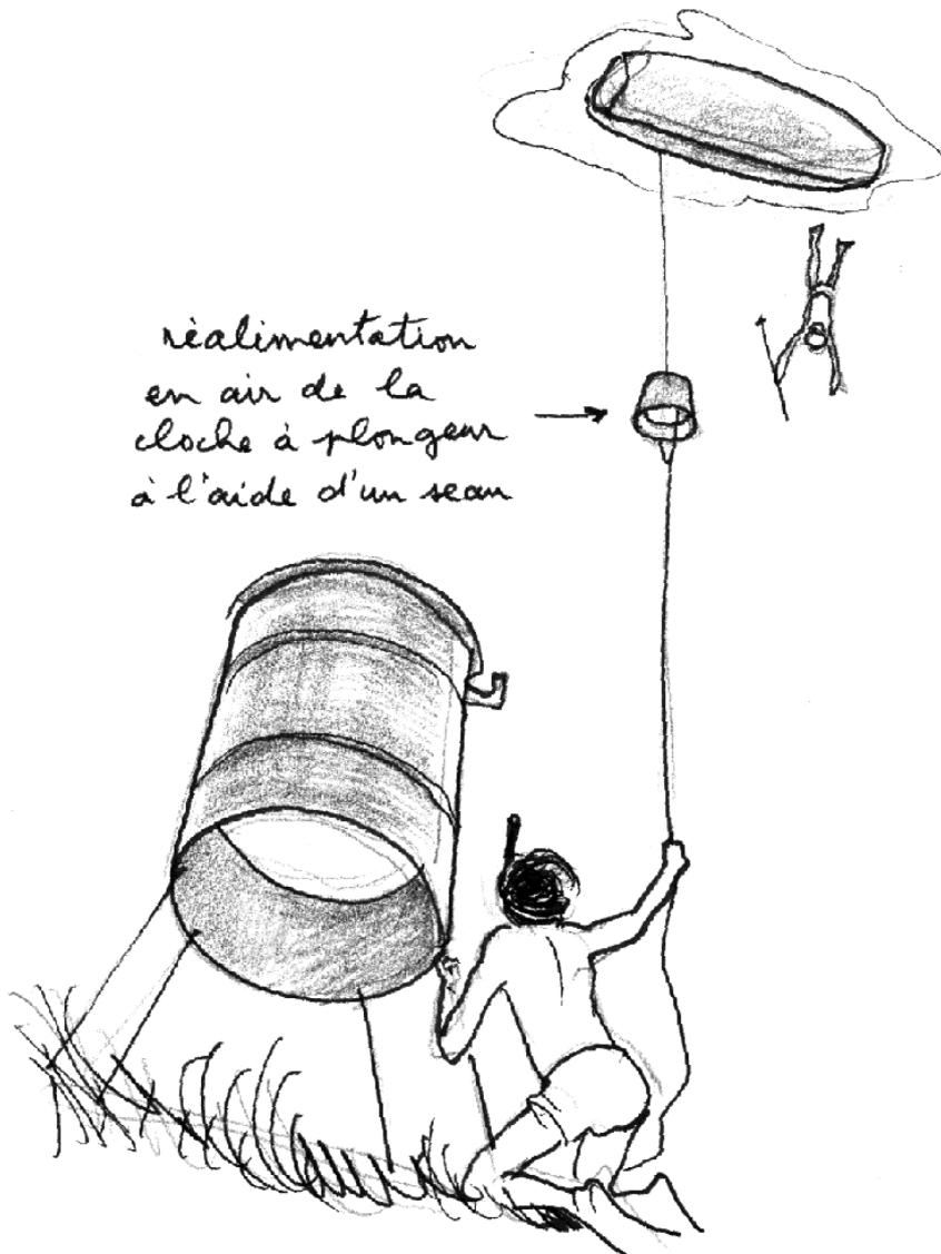
Le passager de cette étrange nacelle combinait ses manœuvres avec celles d'un camarade resté en surface, et ainsi, avec un seau de dix litres, nous pouvions descendre, après l'avoir renversé, de l'air au fond. En fait, à cause de la pression, à dix mètres, nous ne récupérions que cinq litres.
